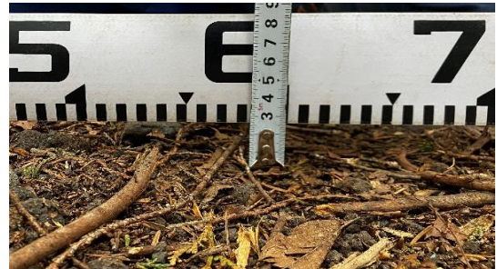
④ モニタリングポイント(洗掘高)
