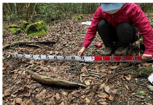
④ モニタリングポイント(洗掘高)
