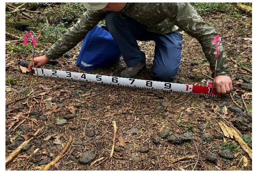
④ モニタリングポイント(洗掘高)
