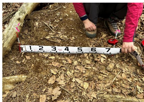
④ モニタリングポイント(洗掘高)
