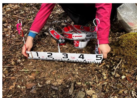
④ モニタリングポイント(洗掘高)
