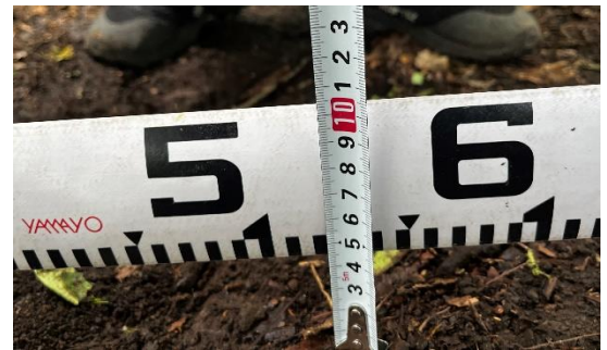
④ モニタリングポイント(洗掘高)
