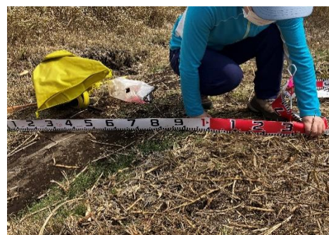
④ モニタリングポイント(洗掘高)
