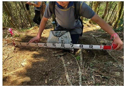
④ モニタリングポイント(洗掘高)
