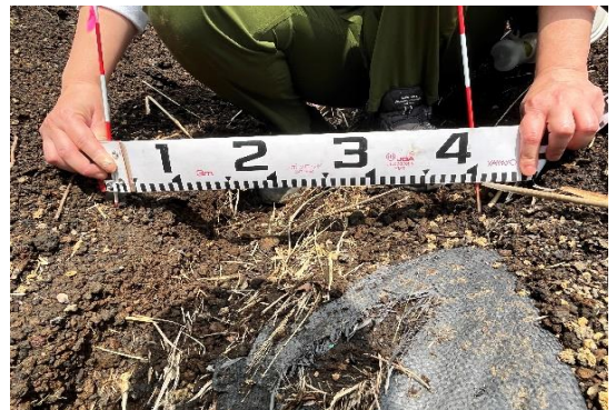
④ モニタリングポイント(洗掘高)
