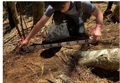
④ モニタリングポイント(洗掘高)
