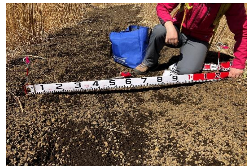
④ モニタリングポイント(洗掘高)
